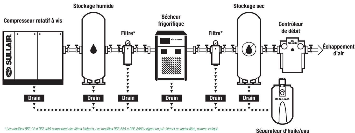
\* Les modèles RFE-03 à RFE-459 comportent des filtres intégrés. Les modèles RFE-555 à RFE-2083 exigent un pré-filtre et un après-filtre, comme indiqué.
